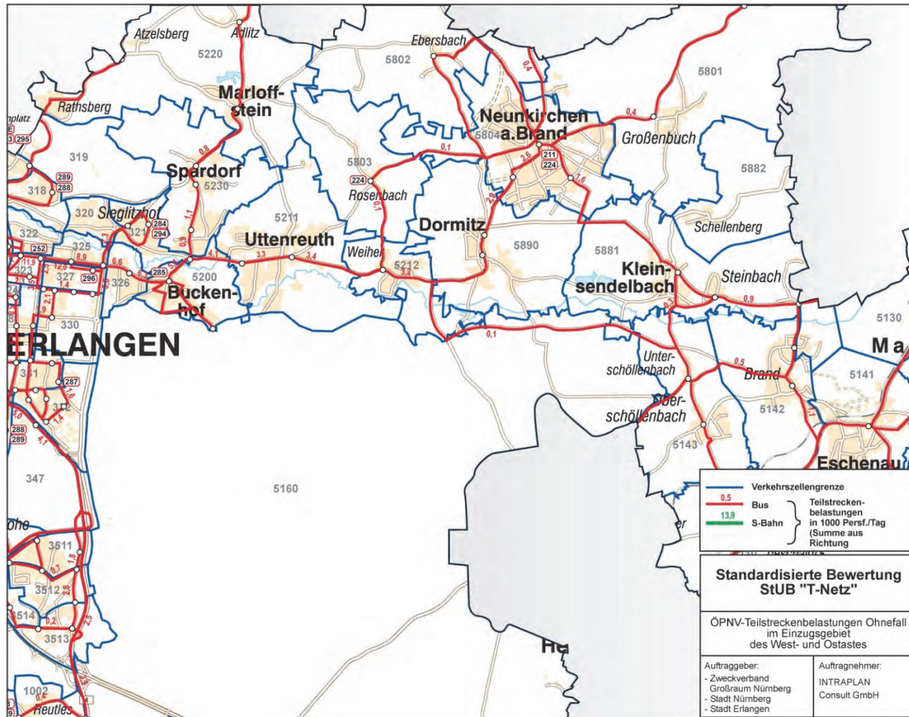
Abbildung 5-3 Teilstreckenbelastungen im Ohnefall (Ausschnitt Erlangen - Eschenau) in Tsd. Personenfahrten/24h (Summe aus Richtung und Gegenrichtung)
